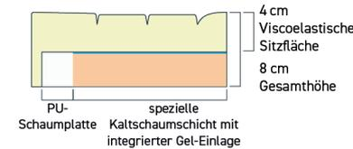
Schematische, technische Illustration eines Kissen-Ausschnitts
